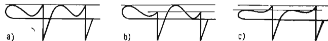
Fig. 38. - Forme d'onda dell'oscillatore orizzontale - a) Forma corretta - b) e c) Forme errate.
