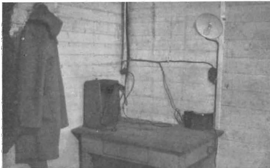
Posto radiotelefonico sperimentale funzionante in simplex installato in una baracca rifugio. (foto dell'Autore)
